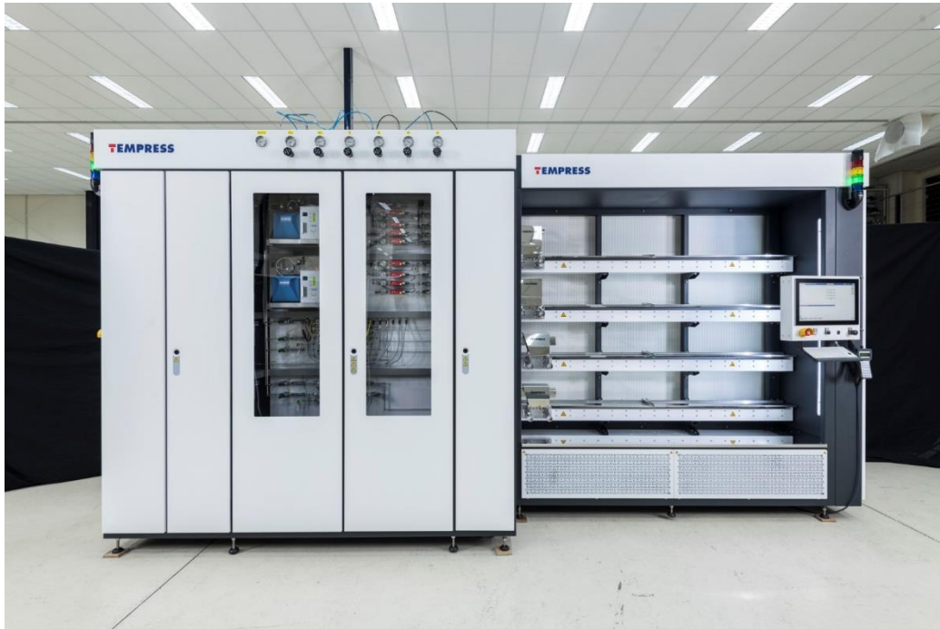
Brand: Tempress , Model: TS-Series V Furnace: AFK
